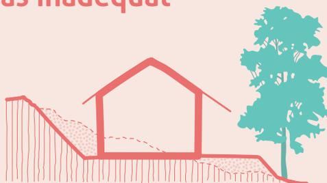
La maison posée en plateforme sur la pente ne respecte pas le terrain naturel et impose un volume important de déblais/remblais. Les talus sont difficiles à aménager, et coûteux à stabiliser.
