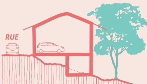
**La maison accompagne la pente et s'adapte au terrain**, en jouant avec les différents niveaux en fonction du degré d'inclinaison. Le volume des déblais/remblais est réduit. **Les accès directs sont possibles** à tous les niveaux.
